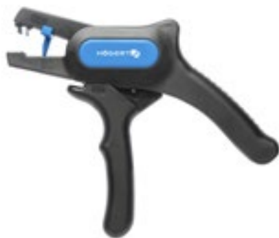
Automata blankoló fogó, 180 mm, 0,2-6,0 mm 2 , szabályozható blankolási távolság (8-20 mm), SK5 nemesacél
