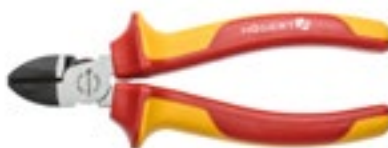
Oldalcípőfogó, 1000 V, CrNi, 160 mm, VDE, CrV acél Nagy keménységű 55-60 HRC vágóélek
