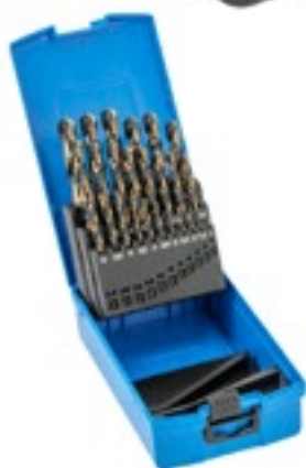
Fúrószár készlet fémhez, 25 db-os, HSS acél, csúcshög 135°, 1-13 mm-ig Fúrószárkészlet acél, öntöttvas, színes- fémek és edzett műanyagok fúrásához HT6D800
