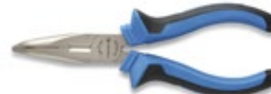
Rádiós fogó hajlítót 160 mm, 58-62 HRC, DIN 5745, CrV acél Hosszabbított, hajlítót fogó drótvágáshoz és hajlításához, közepes és nagy terhelésekhez
