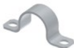
Csőbilincs (félbilincs) villámvédelmi szerelőcsőhöz tűzi horganyzott acél (StZn), 50 × 12 × 20 mm Rögzítő furat mérete: d=5,5 mm Szerelőcső kereszt- metszete: 20 mm
