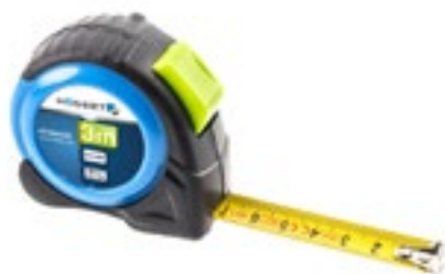
Mérőszalag 3 m x 16 mm, nylon bevonat, kétoldali skálával, MID
