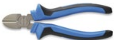
Oldalcípőfogó 160 mm, 58-62 HRC, DIN 5749, CrV acél Oldalcípőfogó drótvágáshoz, közepes és nagy terhelésekhez
