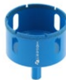
Gyémánt korona fúrófej, 6 mm Gyémánt lyukfúrészek kerámiaanyagok, például mázas csempében és terrakottában történő lyukfúráshoz HT7D306
