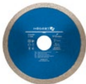
Gyémánt vágókorong, (folyamatos), nehéz csiszolóacél Folyamatos élű gyémánttárcsa sarokcsiszolóhoz és vágógépekhez HT6D701 115 x 1,4 x 1,4 x 22,2 mm
