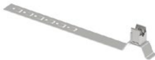
Tető-vezeték-tartó, bepattintós bilincs tetőcserép alá. A festett kivitel 6 különböző RAL-színben rendelhető. Inox, 330 × 25 × 60 mm, 1 db M6 × 10-es csavar Kőracél keresztmetszet: 8 mm
