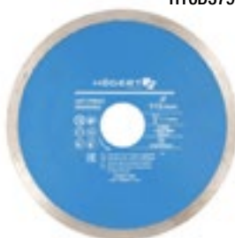
Gyémánt ultravékony vágókorong Fordulatszámig: 13200 1/min. Speciális gyémántréteg szegmensmintával – kerámia anyagok gyors és precíz vágása HT6D756 115 x 1,1 mm
