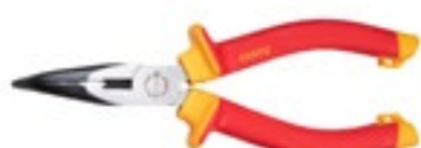
Rádiós fogó hajlítót 160 mm, 1000 V, VDE, CrV acél Indukciós edzésű, nagy keménységű 55-60 HRC vágóélek
